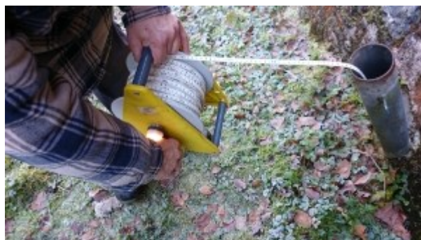
Mesure empirique des sorties de drains et relevés à l'aide d'une sonde piézométrique manuelle standard
