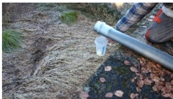
Sorties des drains du masque de Lévy et mesure de leurs débits (de 0 à 90 litres/minute)
