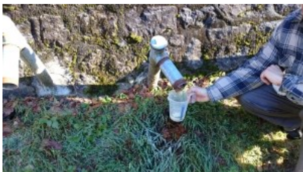
Mesure empirique des sorties de drains et relevés à l'aide d'une sonde piézométrique manuelle standard
